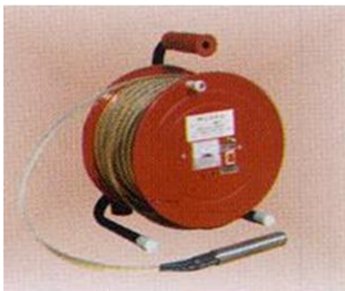
图 6.13-1 钢尺水位测量装置
