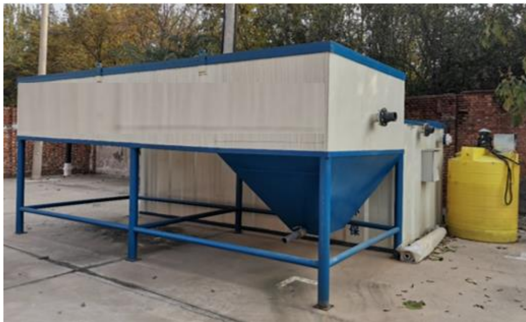
图 6.8-2 Fenton 设备示意图
